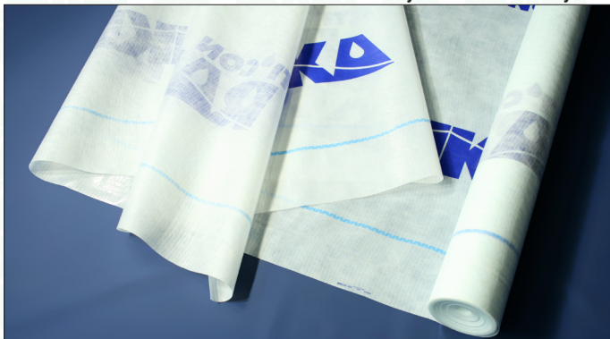
Rankka aluskatte alumine pind on imamisvõimelisest kiudkangast ja pealispind veekindlast mitmekihilisest laminaadist.
